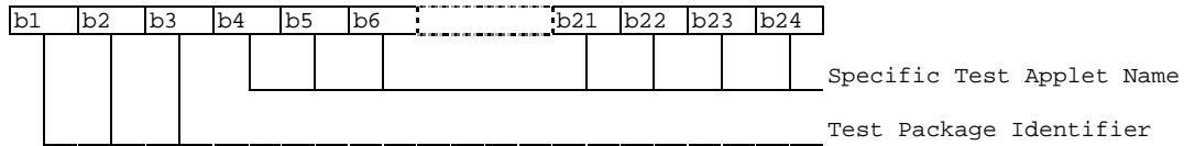
Test package Identifier( bits b1-b3):
