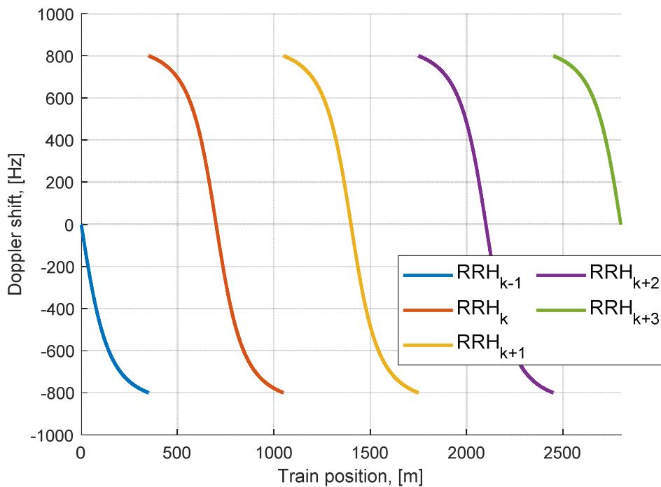
**Figure B.3.3-2 Doppler shift trajectory ( $f_d = 870$  Hz)**
