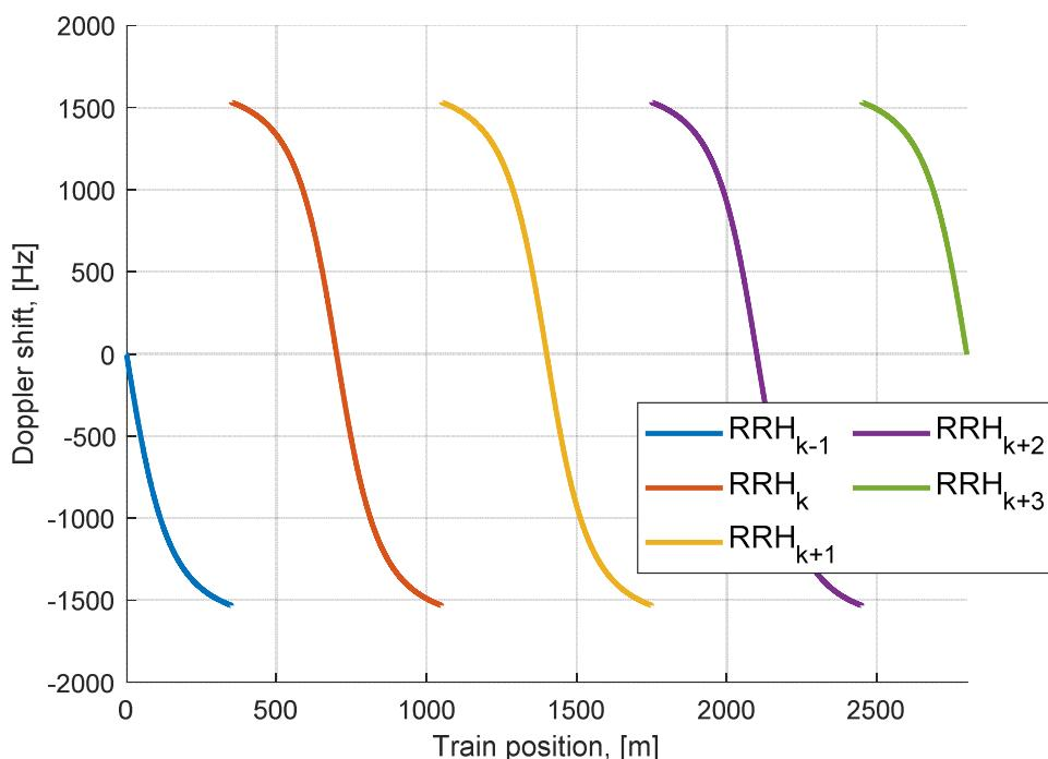
**Figure B.3.3-3 Doppler shift trajectory ( $f_d = 1667$  Hz)**
