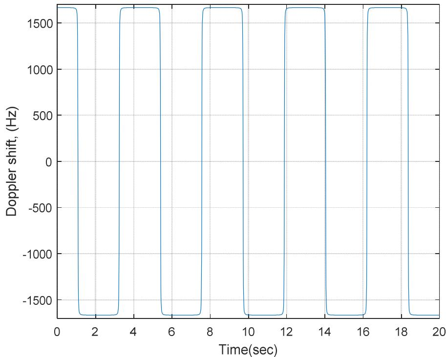
**Figure B.3.1-4: Doppler shift trajectory ( $f_d = 1667$  Hz)**
