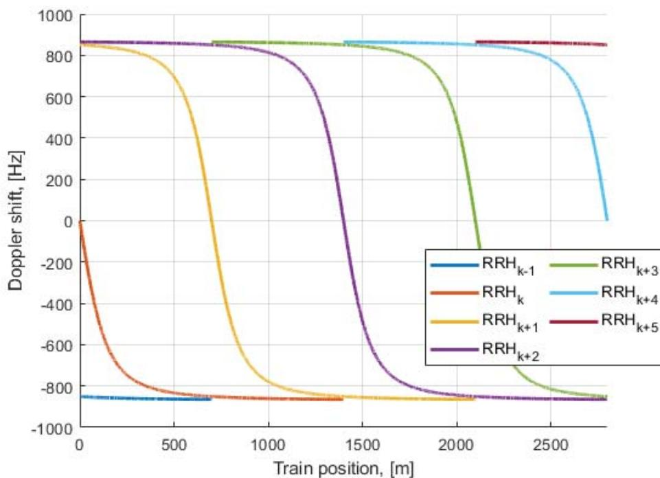
**Figure B.3.2-3 Doppler shift trajectories ( $f_d = 870$  Hz)**
