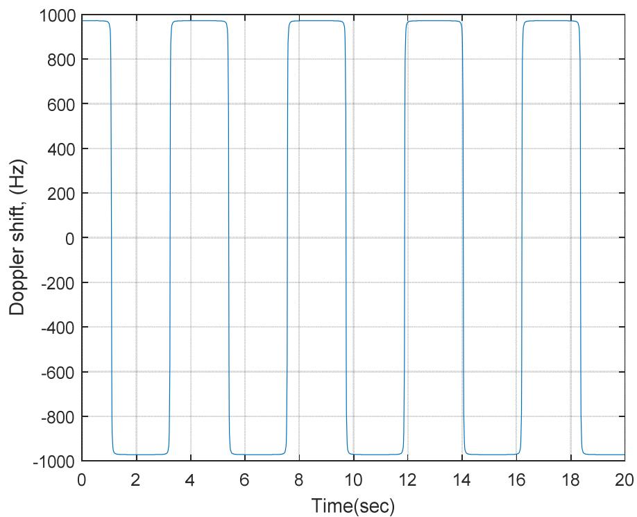
Figure B.3.1-3: Doppler shift trajectory ( $f_d = 972$  Hz)
