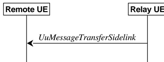
**Figure 5.8.9.9.1-1: Uu message transfer in sidelink**
