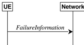
**Figure 5.7.5.1-1: Failure information**
