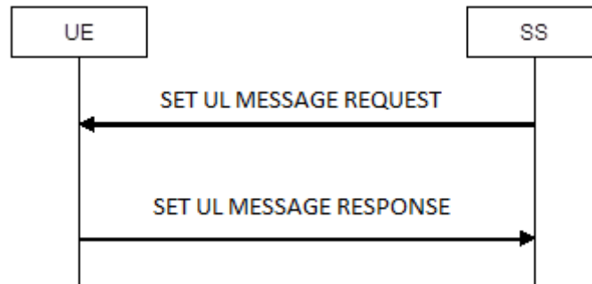
Figure 5.10.1-1: Set UL Message test procedure
