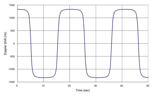
Figure B.3-1: Doppler shift trajectory for scenario 1
