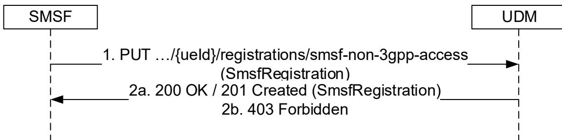
**Figure 5.3.2.2.6-1: SMSF registering for Non 3GPP Access**
