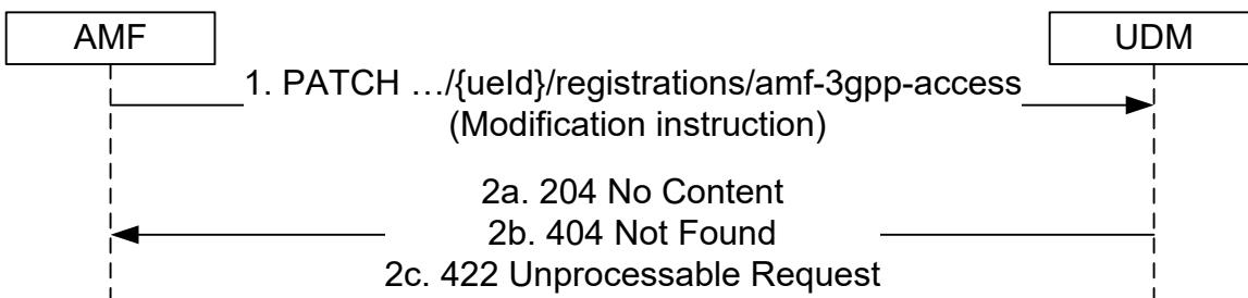
**Figure 5.3.2.6.2-1: AMF registration parameter update for 3GPP access**
