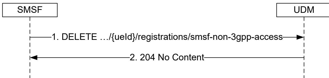
**Figure 5.3.2.4.6-1: SMSF Deregistering for Non 3GPP Access**
