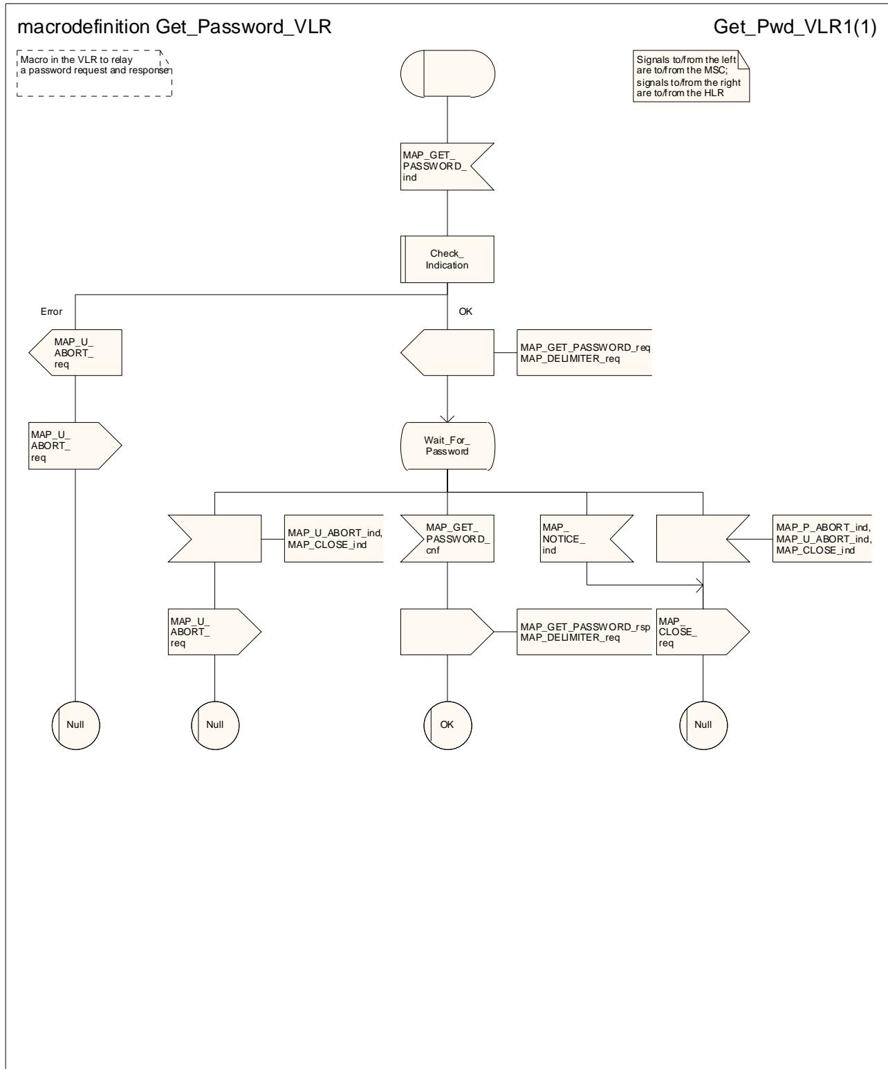
**Figure 22.11.1/2: Macro Get\_Password\_VLR****Figure 22.11.2/1 void****Figure 22.11.2/2 void****Figure 22.11.2/3 void****Figure 22.11.2/4 void**
