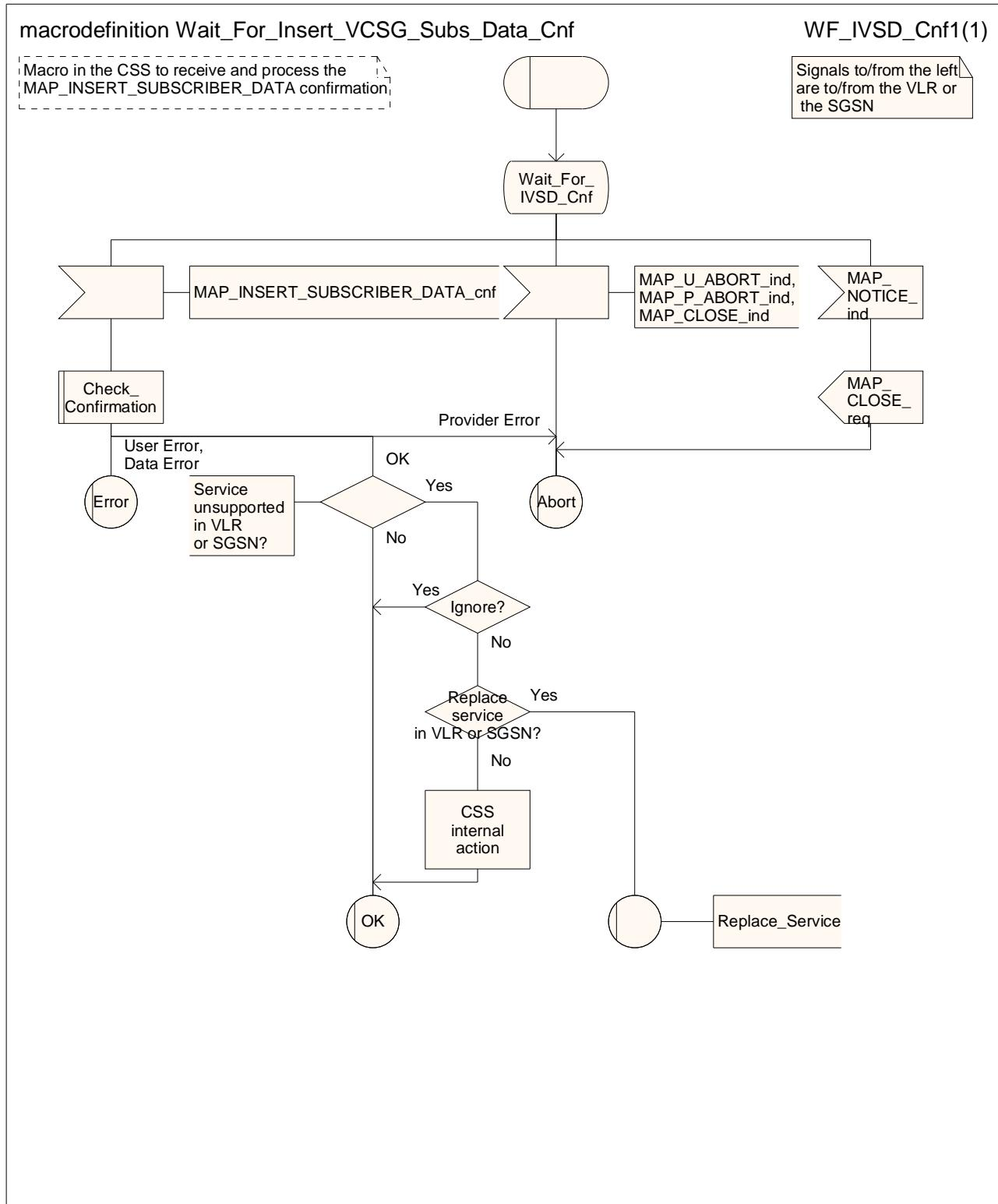
Figure 25.7/9: Macro Wait\_for\_Insert\_VCSG\_Subs\_Data\_Cnf
