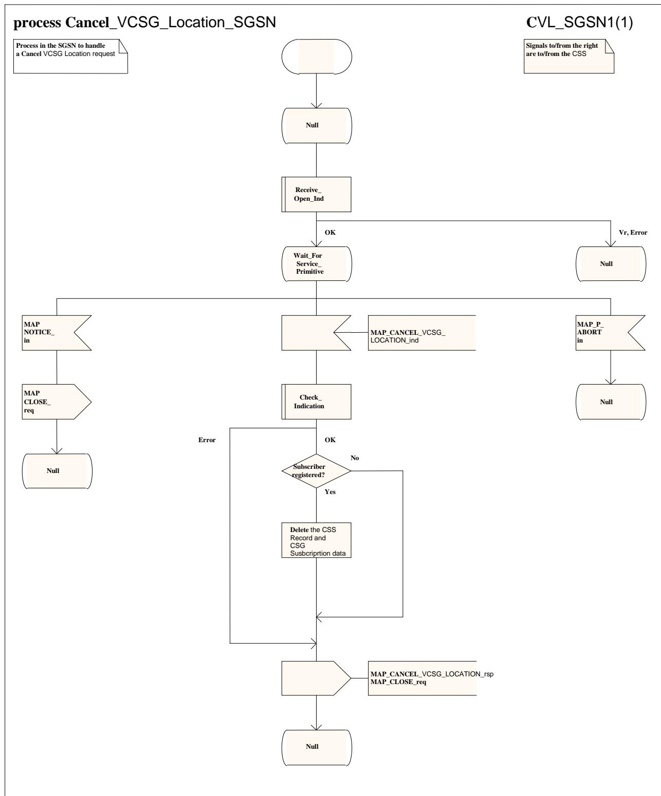
Figure 19.1.2A/4: Process Cancel\_VCSG\_Location\_SGSN
