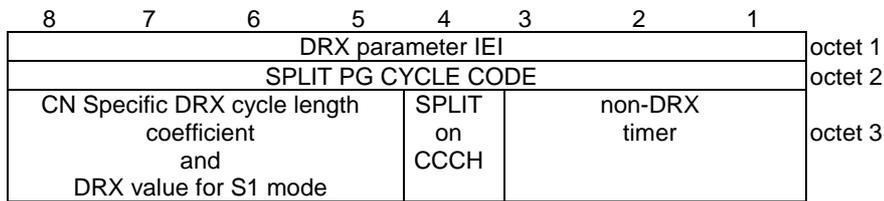
**Figure 10.5.122/3GPP TS 24.008: DRX parameter information element**
