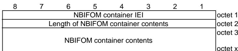
**Figure 10.5.6.21-1/3GPP TS 24.008: NBIFOM container information element**
