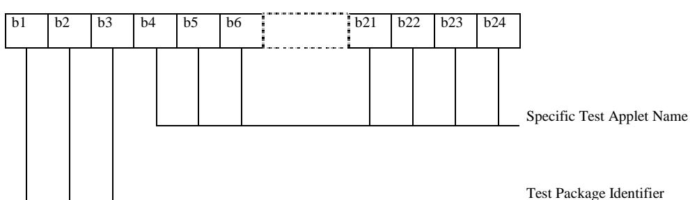
Test package Identifier( bits b1-b3):
