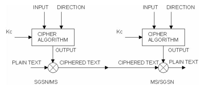
Figure D.4.2: Use of the INPUT parameter
