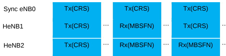
Fig. 6.4.2.1.2-1 Tracking using MBSFN Subframes
