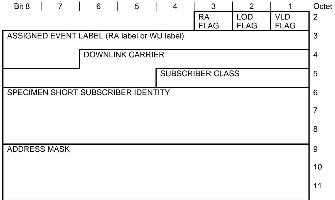
**Figure 100: Assign element**
