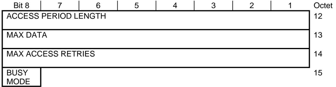
**Figure 91: Access parameters element**
