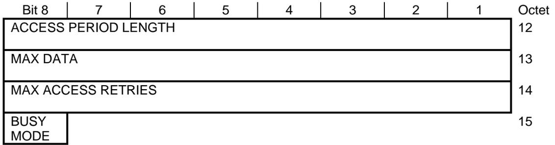
**Figure 91: Access parameters element**
