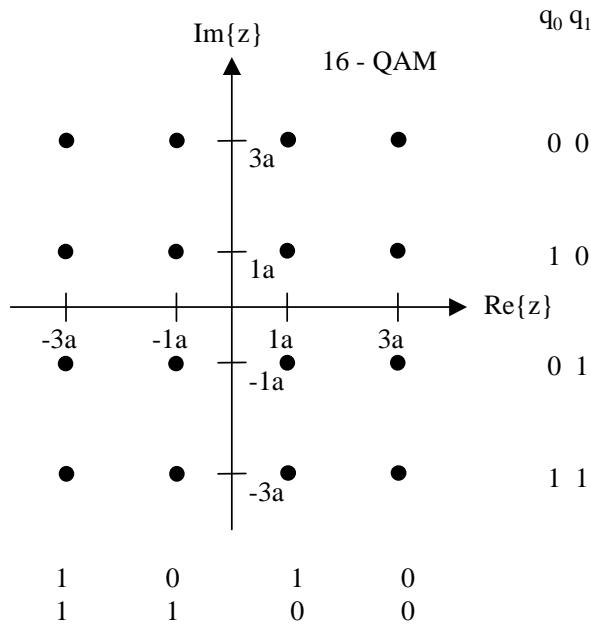
Bit ordering:  $\{i_0 \ i_1 \ q_0 \ q_1\} = \{y'_0 \ y'_1 \ y'_2 \ y'_3\}$
