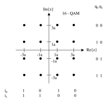
Bit ordering:  $\{i_0 i_1 q_0 q_1\} = \{y'_0 y'_1 y'_2 y'_3\}$
