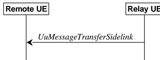
**Figure 5.8.9.9.1-1: Uu message transfer in sidelink**
