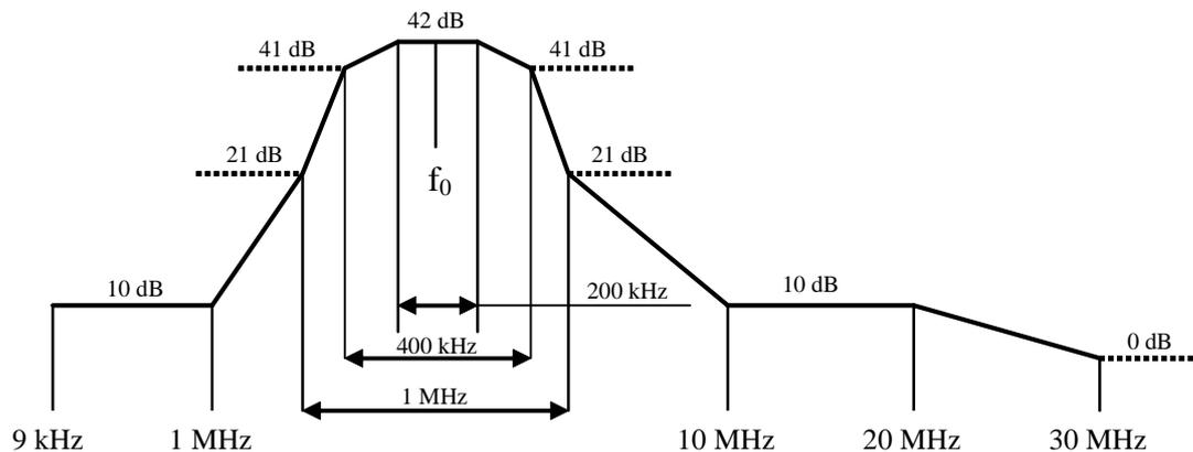
Figure 4.3.1.2.1: Modem attenuation
