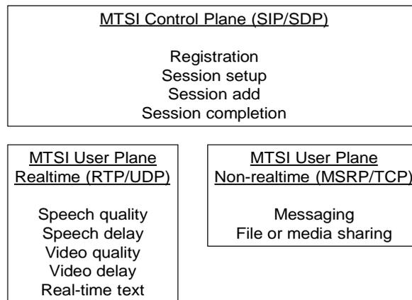
**Figure 47: MTSI parameter structure**
