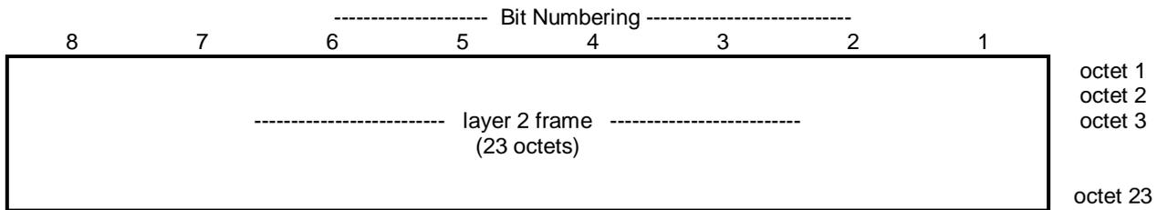
**Figure 9.4.1: S-FACCH/S-SDCCH Reverse Block Format**
