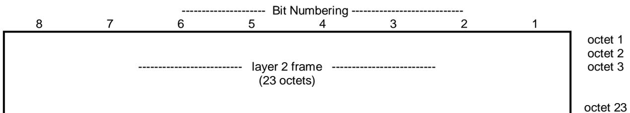
**Figure 9.3.1: S-FACCH/S-SDCCH/S-BCCH/S-AGCH/S-PCH Block Format**
