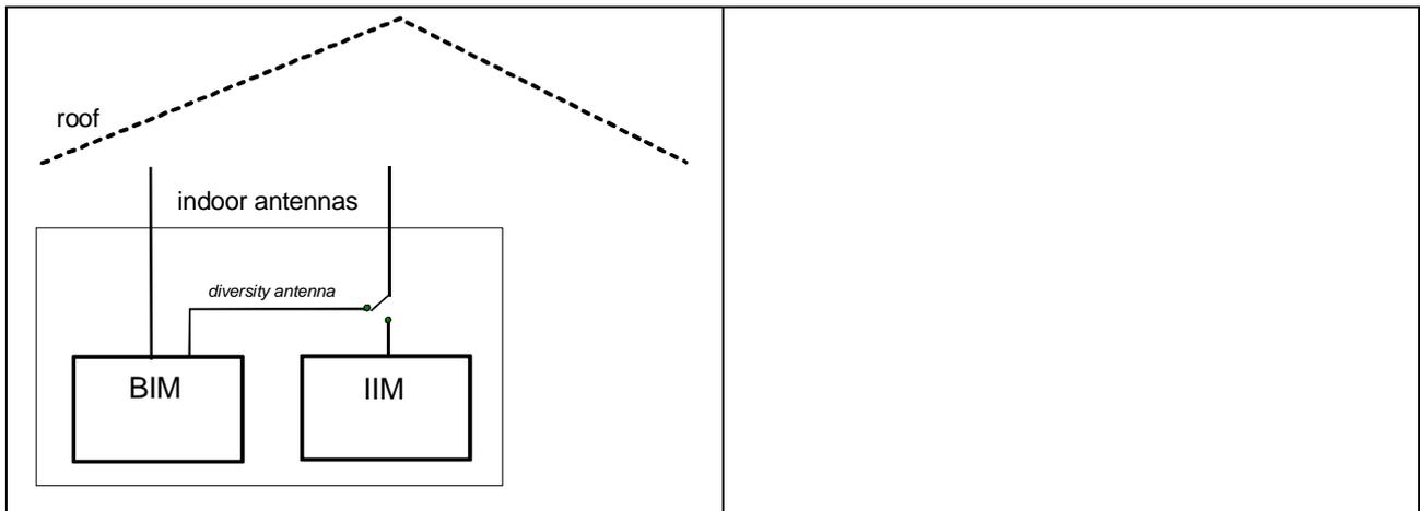
**Figure 61: antenna arrangements**
