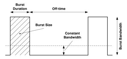
Figure 7: Burst parameters
