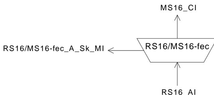
**Figure E.7: RS16/MS16-fec\_A\_Sk symbol**
