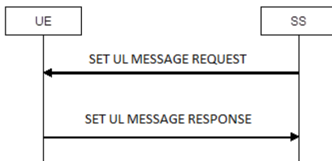
Figure 5.10.1-1: Set UL Message test procedure
