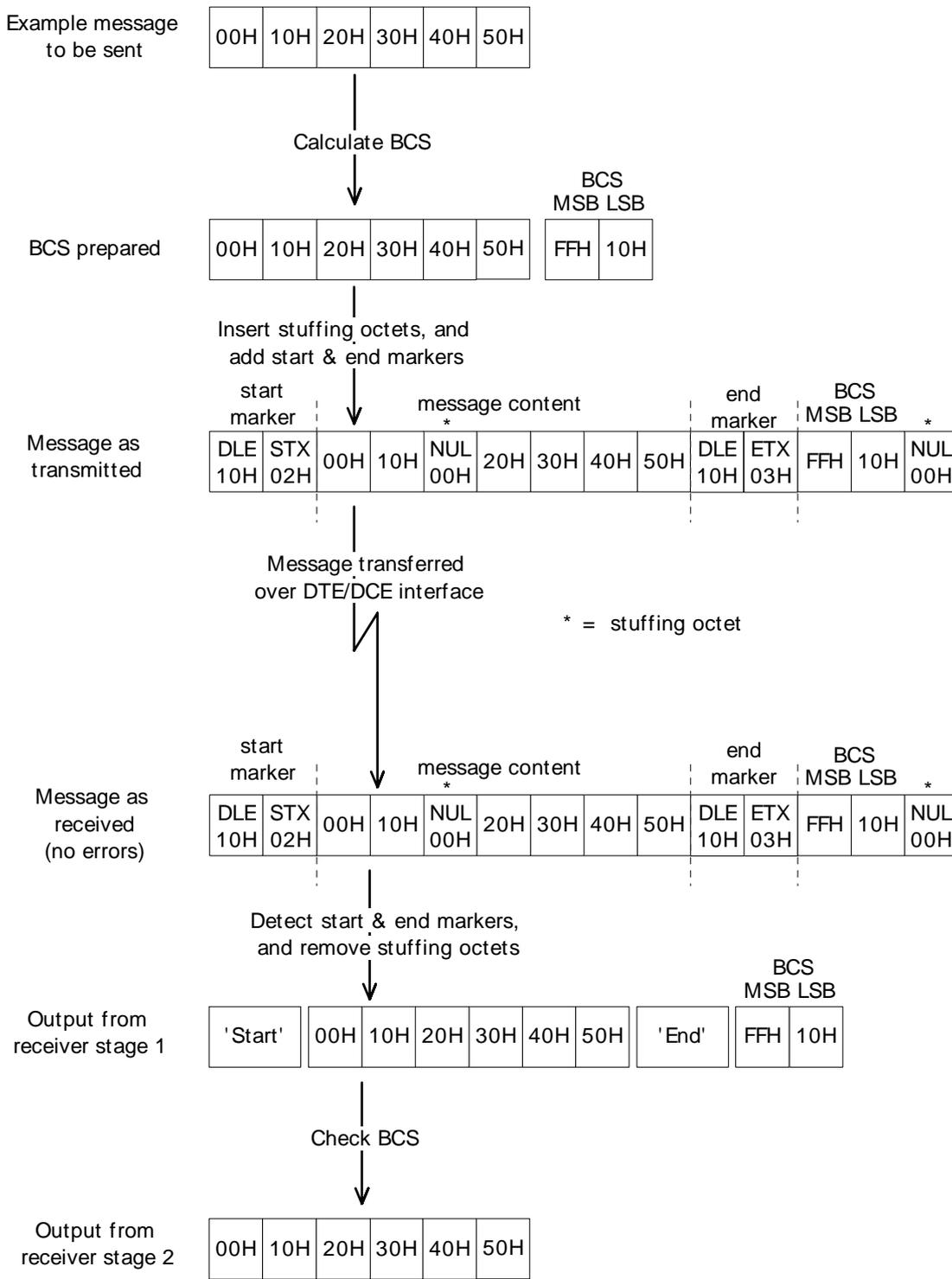
**EXAMPLE STATE DIAGRAMS FOR THE BLOCK RECEIVER**
