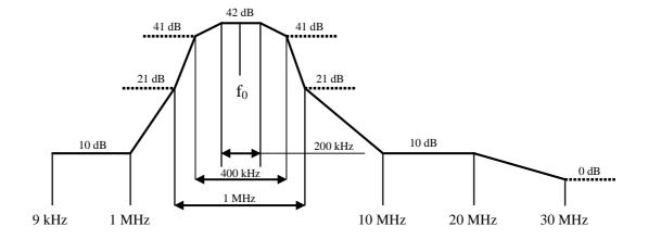
Figure 4.3.1.2.1: Modem attenuation
