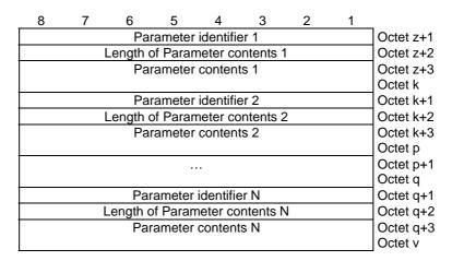
Figure 10.5.144c/3GPP TS 24.008: Parameters list
