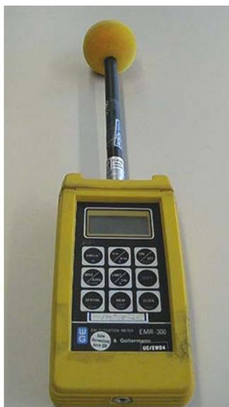
**Figure B.10: EM Radiation Meter EMR-300**
