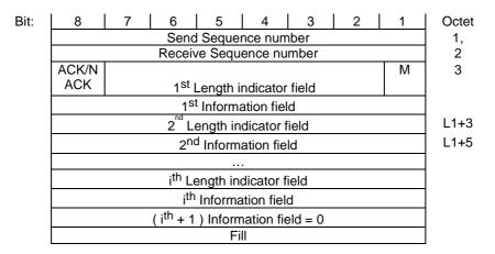
Figure 12.11.1.2: Frame format type FU10b
