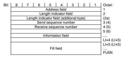
Figure 12.6.1.1: Frame format type FU5a
