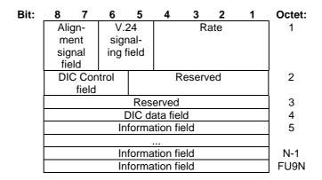
Figure 11.11.1.1.1: Frame Format Type FU9
